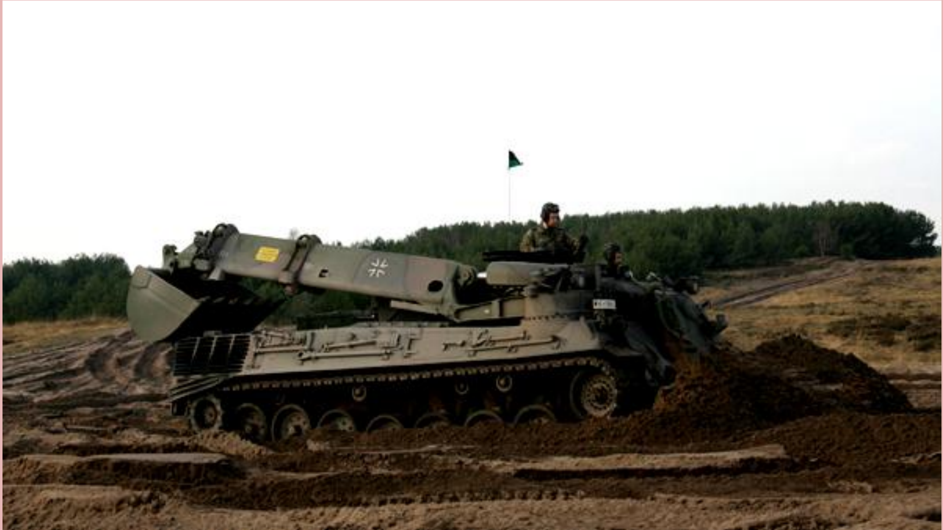
Der Pionierpanzer „Dachs“ oder Pionierpanzer 2, in der Pionierkompanie 350, gehört zur Gruppe der Kampfunterstützungsfahrzeuge er ist der Nachfolger des Pionierpanzer 1. Eingesetzt wird das Fahrzeug bei den Pionieren und Panzerpionieren des Heeres der Bundeswehr.
