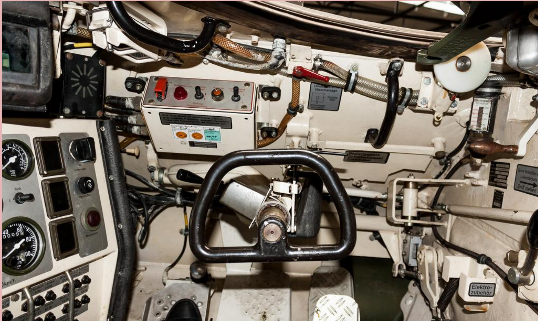
Der Platz des Fahrers (MKF) mit den Bedien- und Anzeigegeräten.
