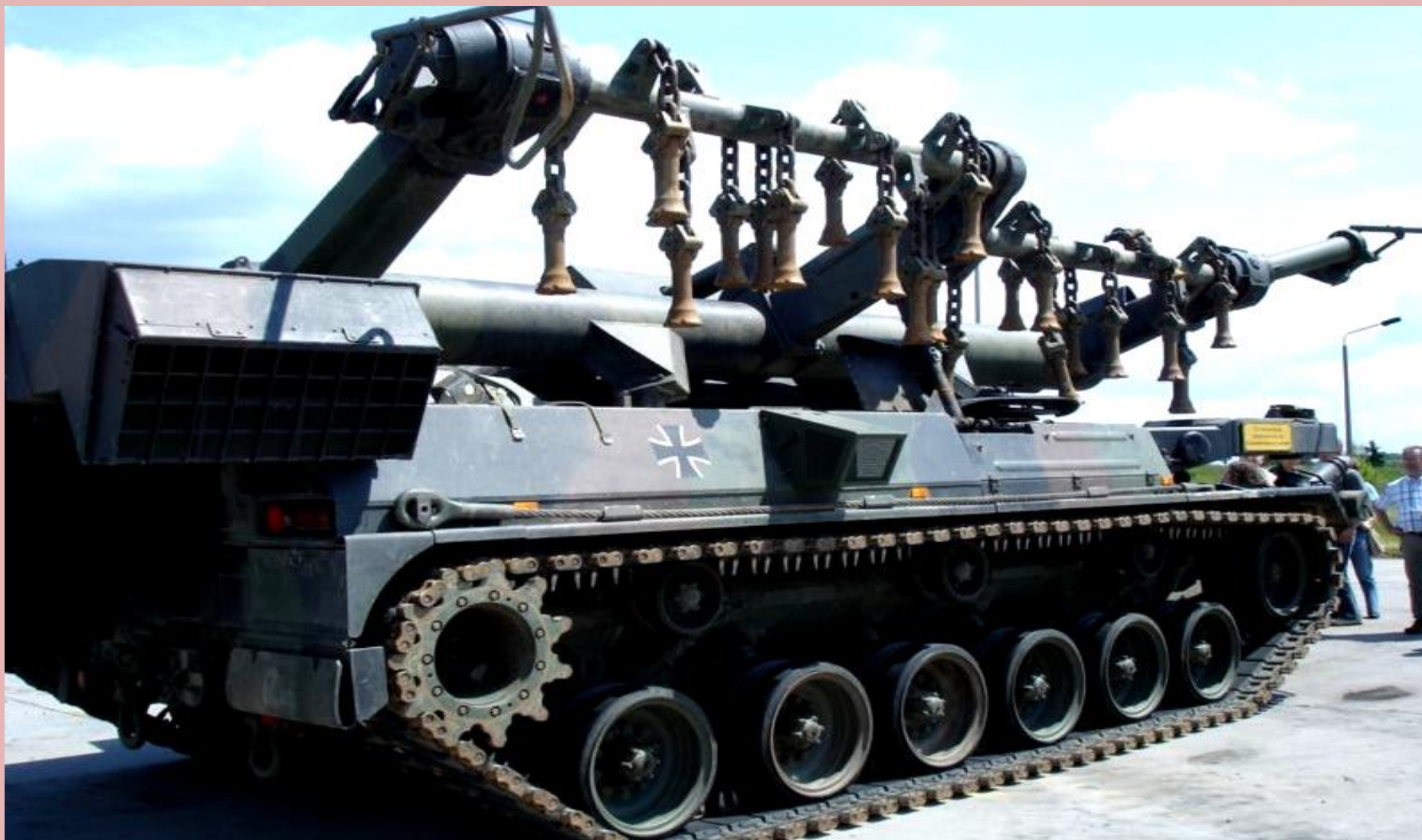
Minenräumpanzer „Keiler“, in der Pionierkompanie 350.
