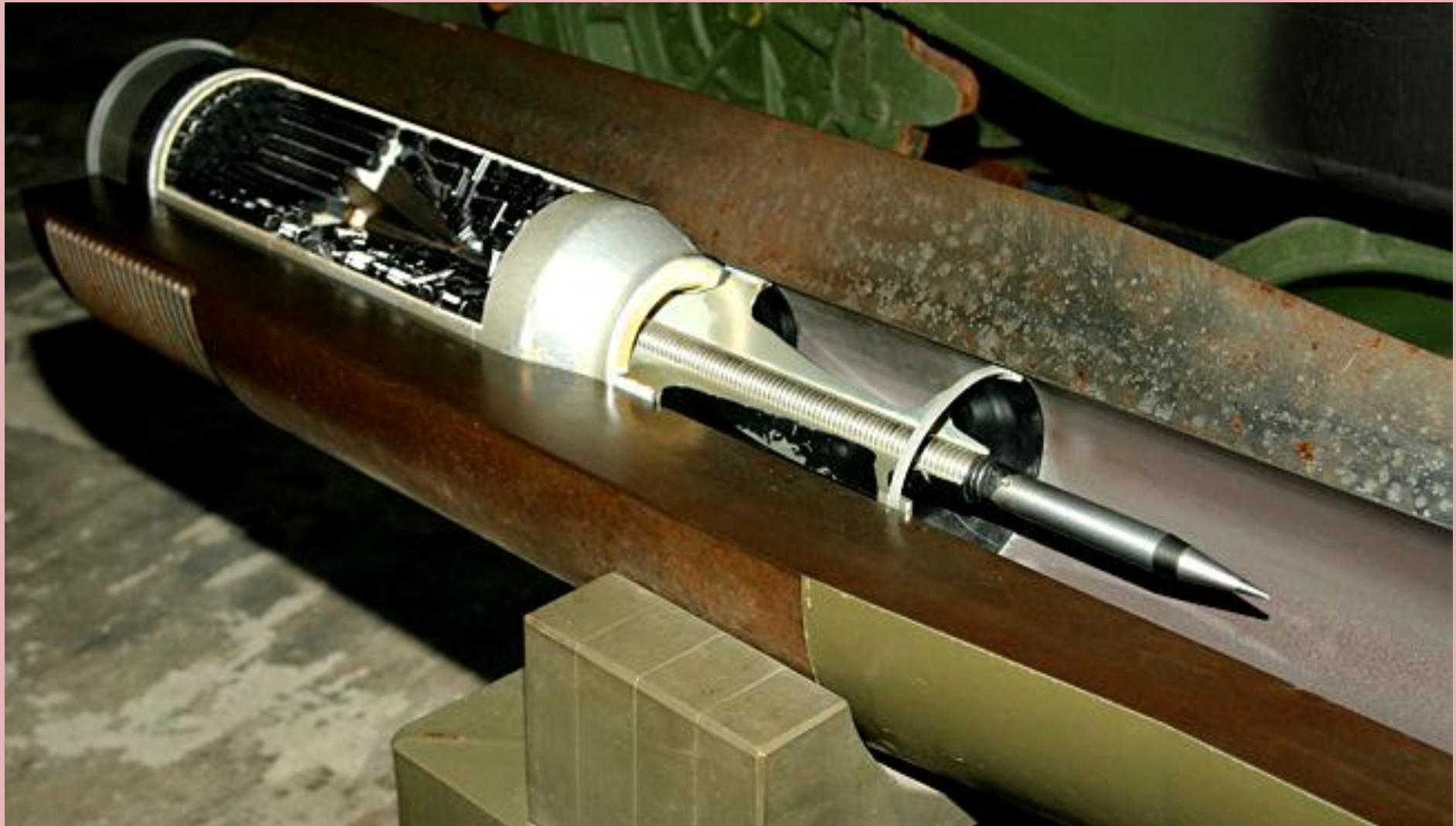
Ein Modell der „KE-Munition“ (kinetische Energie), im Patronenlager der 120 mm Glattrohrkanone.
