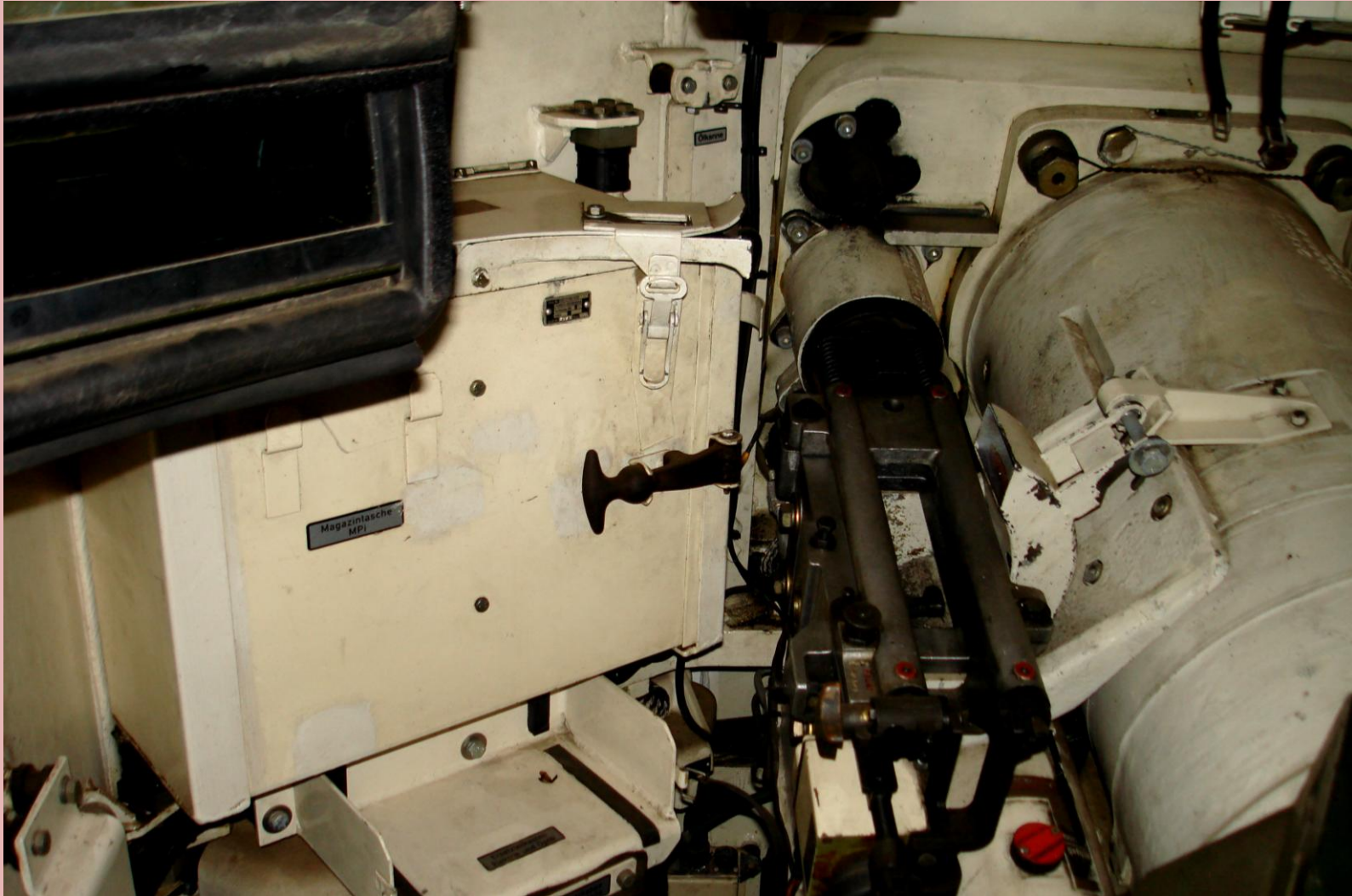
Ladeschützenplatz des Leopard 2 mit Lafette des Blenden-MGs, ganz rechts die Kanone, darunter die Rohrbremse (mit rotem Öldeckel).
