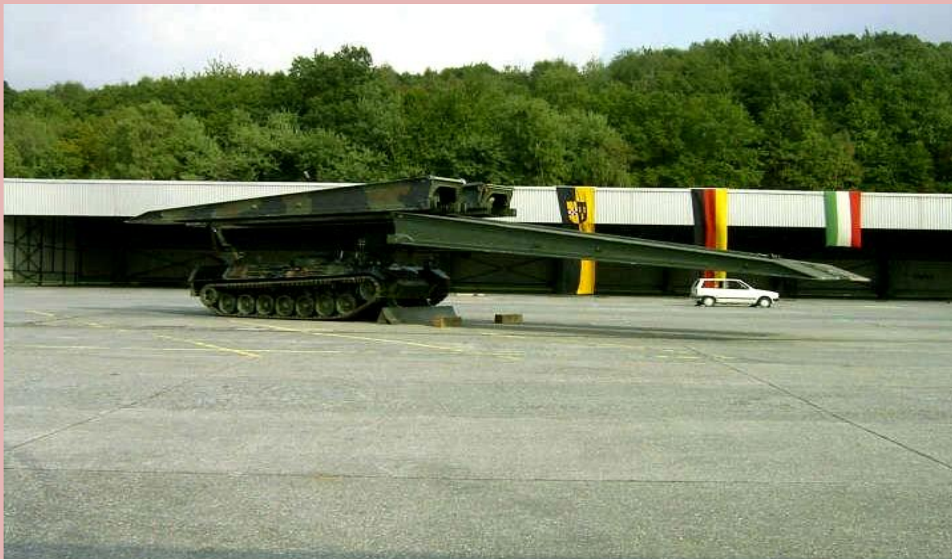
Brückenlegepanzer „Biber“, in der Pionierkompanie 350.
