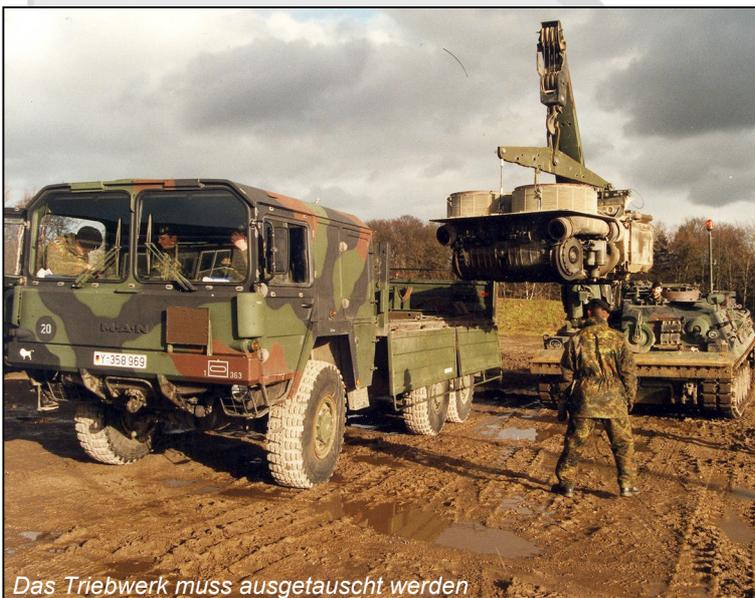
Das Triebwerk muss ausgetauscht werden
