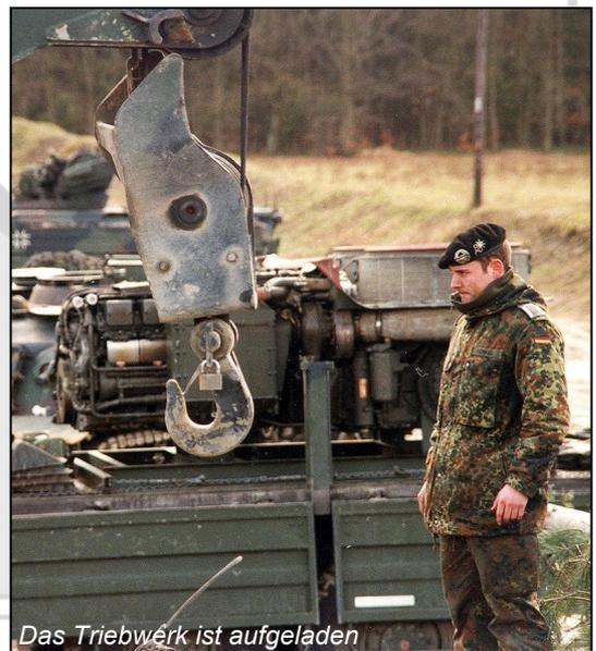
Das Triebwerk ist aufgeladen
