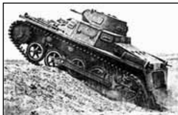
Panzerkampfwagen I mit Zwillingsmaschinengewehr und drehbarem Turm
