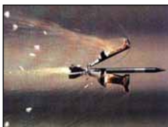
Treibspiegelabtrennung bei einem KE-Geschoss
