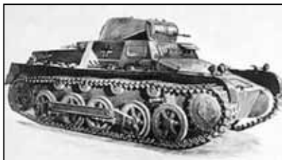
Panzerkampfwagen I mit Zwillingsmaschinengewehr und drehbarem Turm
