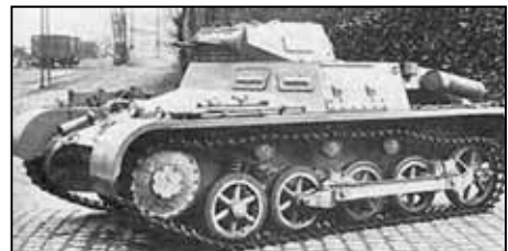
Panzerkampfwagen I mit Zwillingsmaschinengewehr und drehbarem Turm
