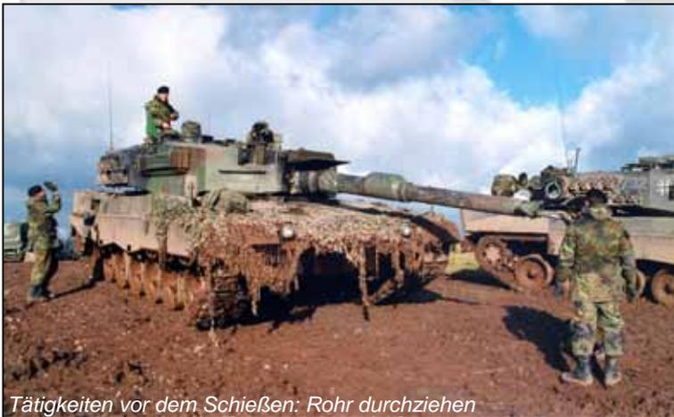
*Tätigkeiten vor dem Schießen: Rohr durchziehen*
